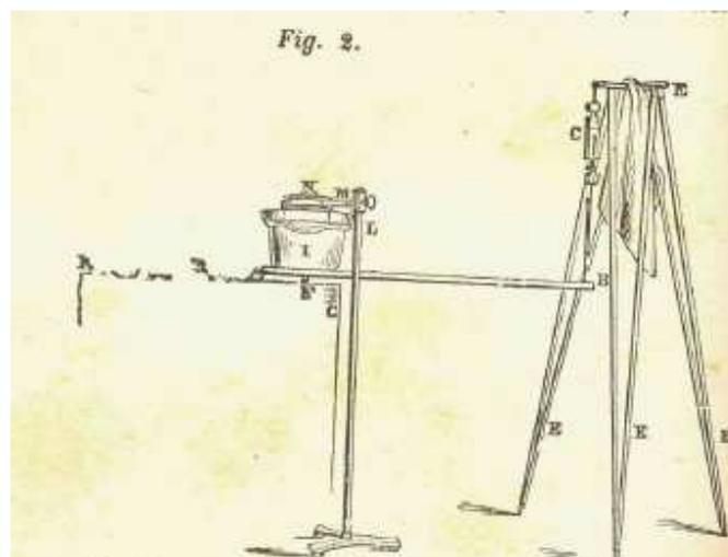
La pièce suivante de l'appareil ne se voit pas dans les figures. A l'index mobile 0 de la balance à ressort est soudée une fine pointe d'acier qui se projette horizontalement en dehors. En face de la balance, et solidement fixé à elle, se trouve un cadre à coulisse portant une boîte plate semblable à la chambre noire d'un appareil photographique.
